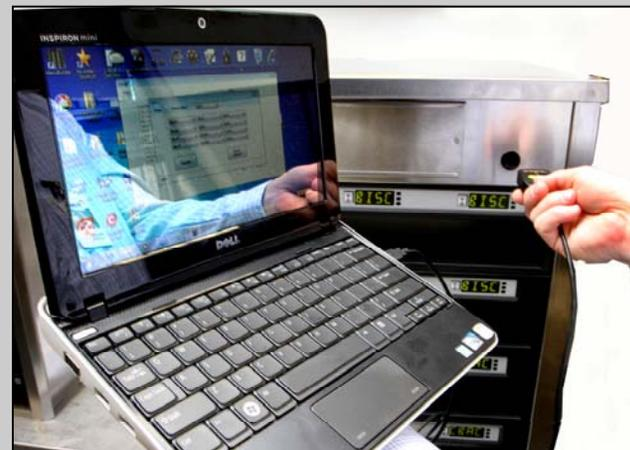
5. Cliquez sur le bouton de transfert dans l'écran du menu et orientez rapidement la clé électronique devant le port de l'armoire. Une boîte de dialogue s'affiche, indiquant un transfert réussi.
