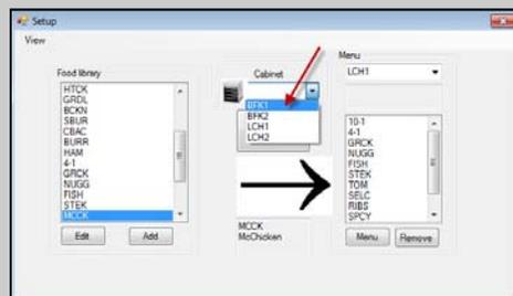
4. Réglez les éléments du menu selon les besoins en cliquant sur les positions de logements et en mettant les éléments souhaités en évidence. Tous les éléments sur la ligne doivent avoir la même température de maintien.
