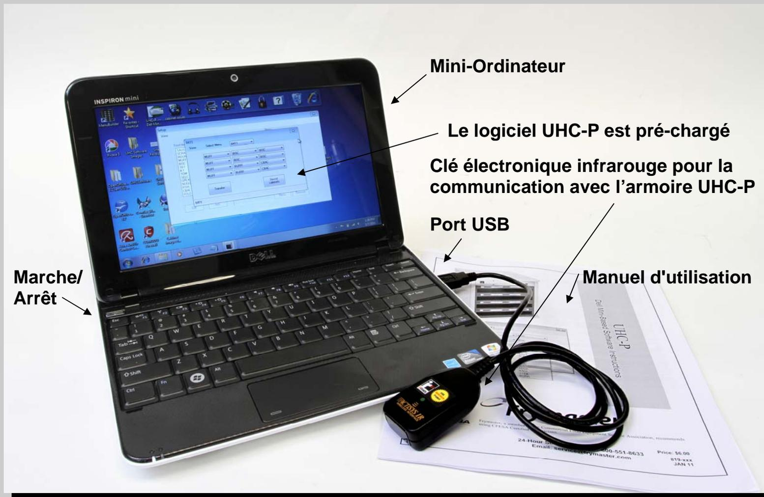
L'ordinateur et la clé matérielle est spécialement configuré pour la communication infrarouge avec le cabinet UHC-P. Ces articles sont spécialement configurés uniquement disponible à partir Frymaster. En termes de fonctionnement, le mini-ordinateur basés sur des logiciels est identique au programme Palm qui a été utilisé de 2006 à 2010.
